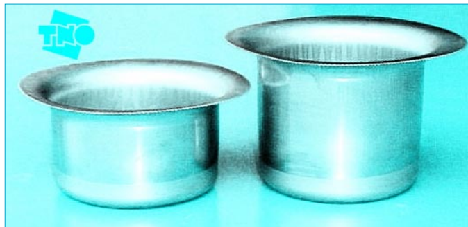
Beker getrokken met een matrijs en plooihouder op 20°C (links, dieptrekverhouding van 2.0) en op 80°C (rechts, dieptrekverhouding van 2.27). Materiaal is 0.7 mm dik AISI 304.
