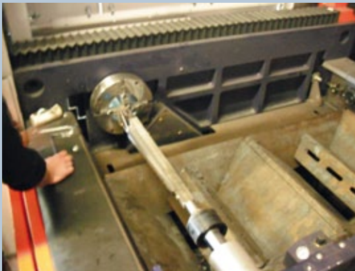
B - Brander ingeklemd op de mal die in de klauwplaat van de laserlasmachine past
